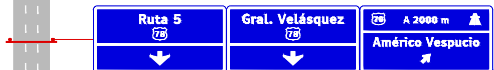
IP a 2000 m de inicio pista salida
