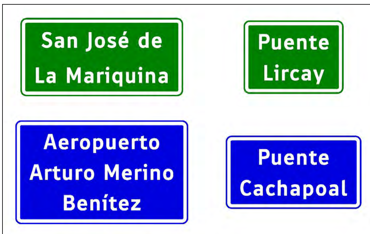
FIGURA 6.302.604.C SEÑALES DE LOCALIZACIÓN
