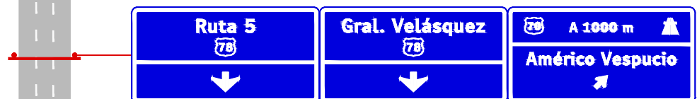
IP a 1000 m de inicio pista salida
