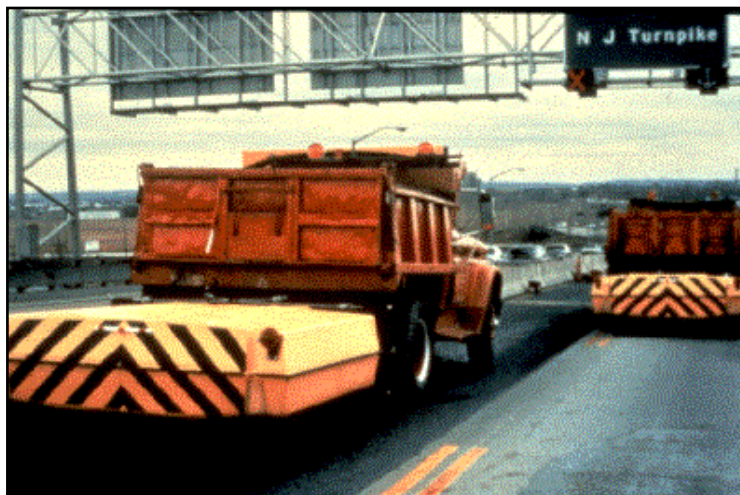
FIGURA 6.503.205.A AMORTIGUADOR O ATENUADOR DE IMPACTO MÓVIL MONTADO SOBRE CAMIÓN.
