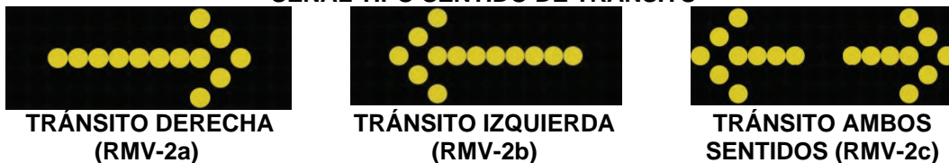
FIGURA 6.304.303(4).A SEÑAL TIPO SENTIDO DE TRÁNSITO
