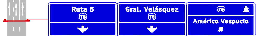
IP a 0 m de inicio pista salida
