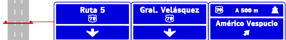
IP a 500 m de inicio pista salida
